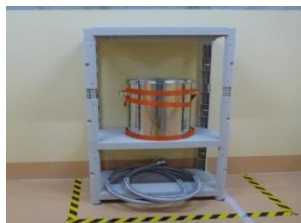
可搬型中性子吸収材供給器
