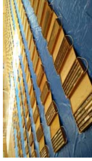
ボーリングで海底から採取した試料
