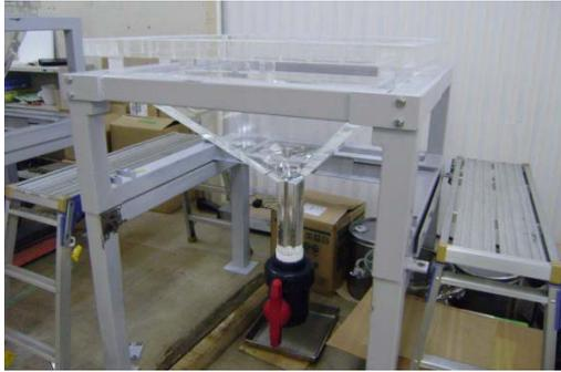
図9 実機スケール流下試験装置
