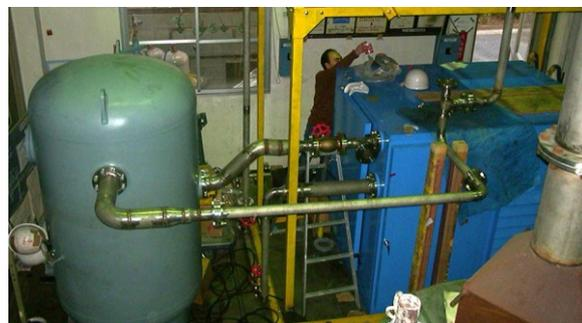
図 14 ガスダイバータ冷却実験高圧ガスループ
