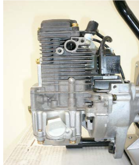
図2 可視化した 25cc、4 ストロークエンジンの外観
