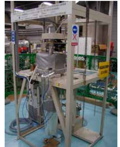
写真5. 内蔵 CRD の高温水中軸受材料の劣化特性試験装置
