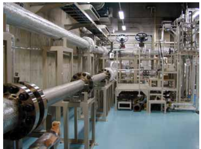
写真2.高温高圧(7.17MPa, 288)伝熱流動実験ループ 水平試験部
