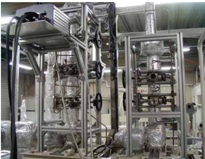
写真1.高温高圧(7.17MPa, 288)伝熱流動実験ループ 垂直試験部
