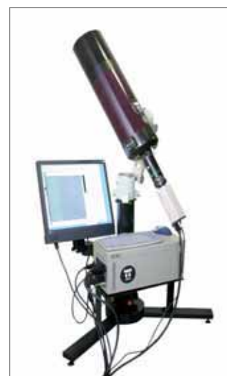
写真3. スーパーロングレンジ PIV システム装置
