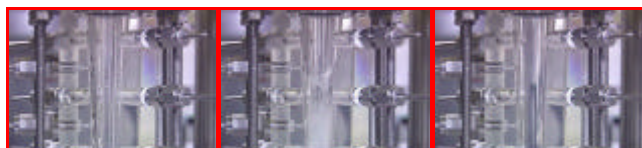
(a) 蒸気注入前 (b) 蒸気注入直後 (c) 水噴流形成 図 3 蒸気インジェクタ起動時の様子
