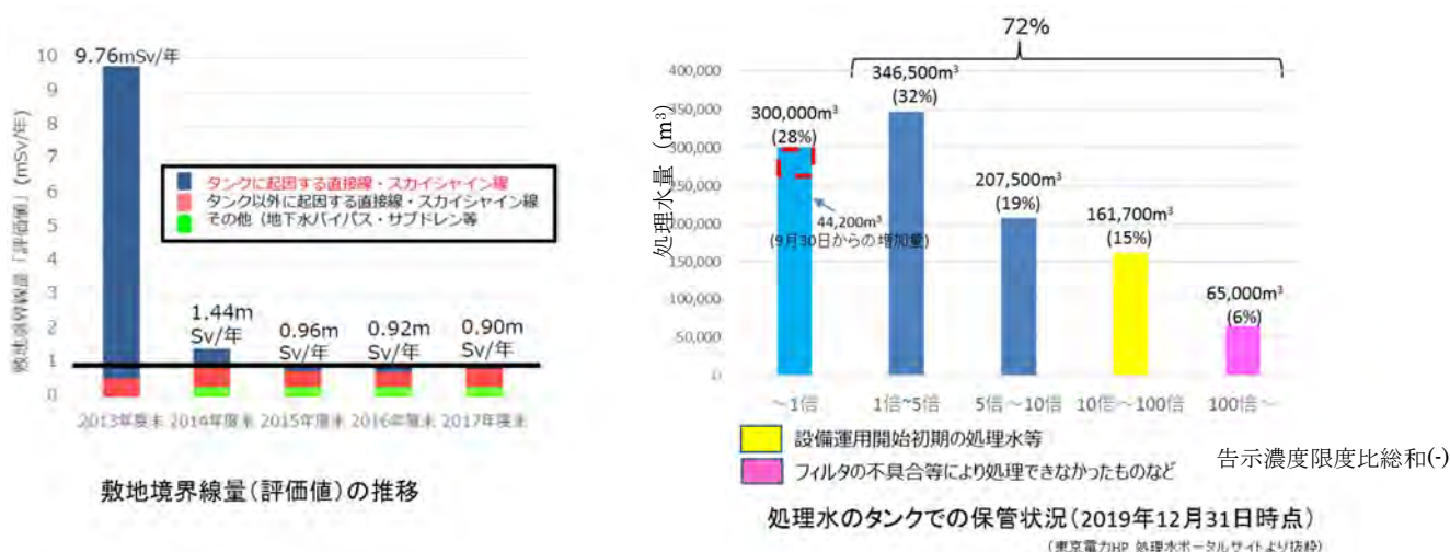
図3. 敷地境界線量(評価値)の推移(左)、処理水のタンクでの保管
