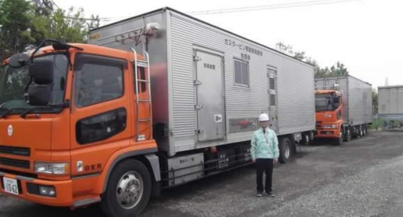
※空冷式GTG：空冷式ガスタービン発電機車
