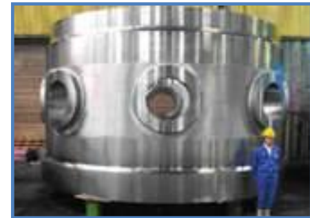
【原子炉圧力容器】
