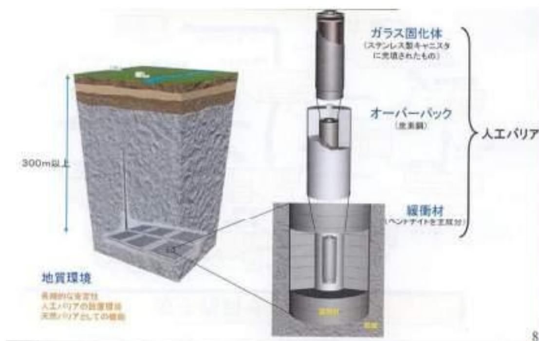
図2 安定な地下深部に工学的な設備（人工バリア）
