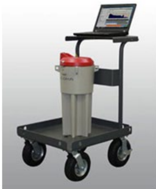
φ2×2インチNaIシンチレーション検出器 を内蔵した食品放射能測定システム
