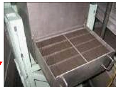
触媒プレート (触媒：白金系金属)
