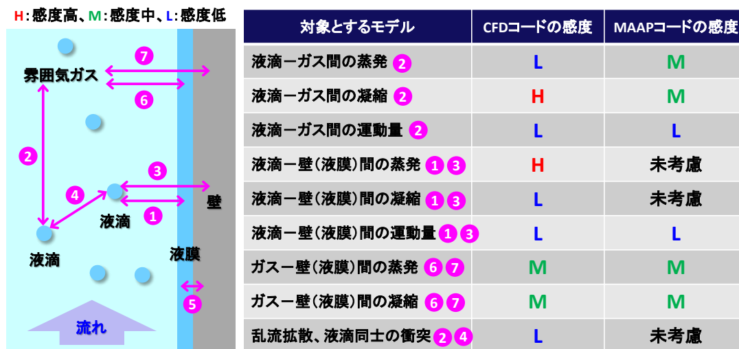
図3 調査対象とした凝縮・蒸発に関わるモデルと感度の比較結果
