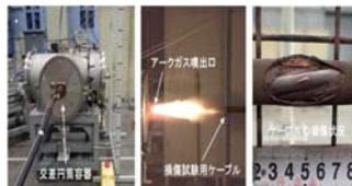
図2 アーク高温ガスによる動力ケーブル曝露試験
