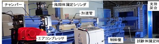
図2 高速貫通試験設備の概観
