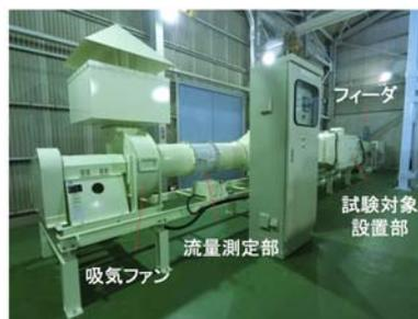
図1 粉塵除去性能評価試験装置の外観
