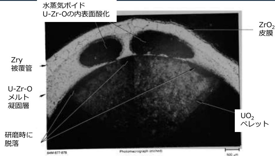
1A粒子の断面（金相写真、エッチング後）[6]
