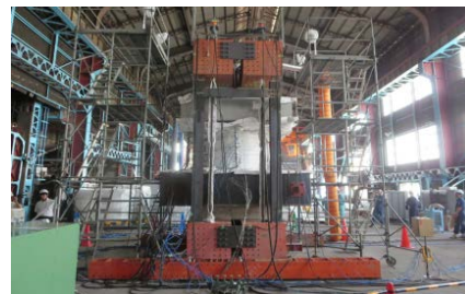
図2 RPVペDESTALの耐力評価試験(縮小模型試験体)
