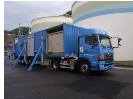
移動式代替熱交換設備
