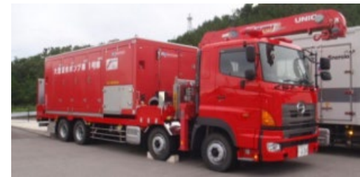
大型送水ポンプ車
