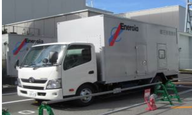
可搬型交流電源設備（高圧発電機車）
