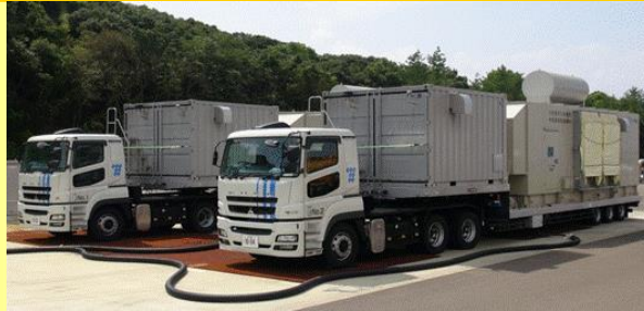
中容量発電機車(1,825kVA-6,600V)
