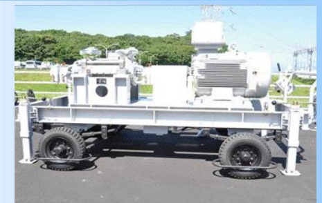
可搬型電動低圧注入ポンプ
