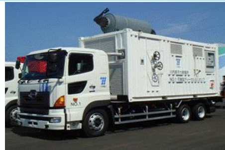
可搬型ディーゼル注入ポンプ
