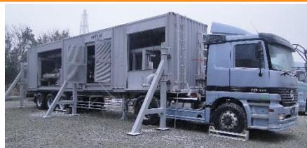
原子炉等の冷却水を海水で冷やす代替設備。
