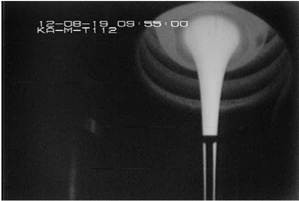
第9図 流下ノズルからのガラス流下の様子 8)
