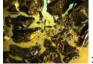
YF主成分 ・モリブデン酸塩 ・クロム酸塩 等 ガラス中YFの外観
