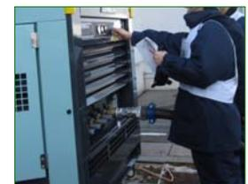
水素掃気用の安全圧縮空気喪失時のエンジン付空気圧縮機による訓練
