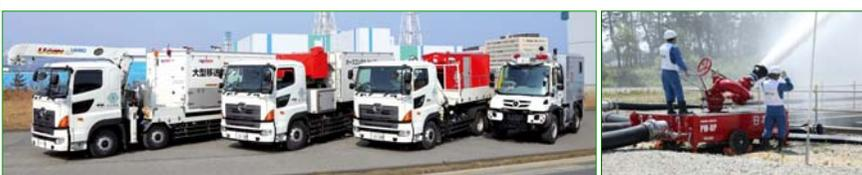
大型移送ポンプ車、ホース展開車、中型移送ポンプ車、不整地走行車
