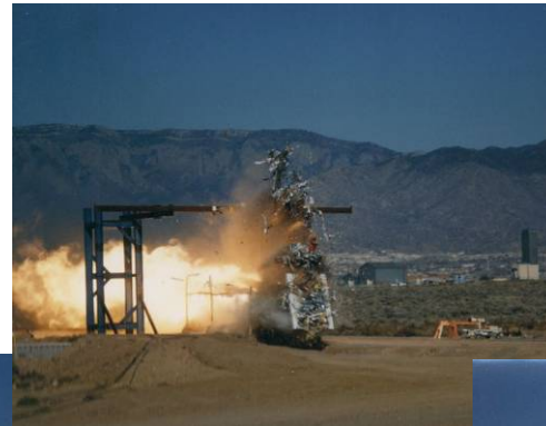
コンテナの固縛装置及び輸送物を模擬した1/5スケールモデル
