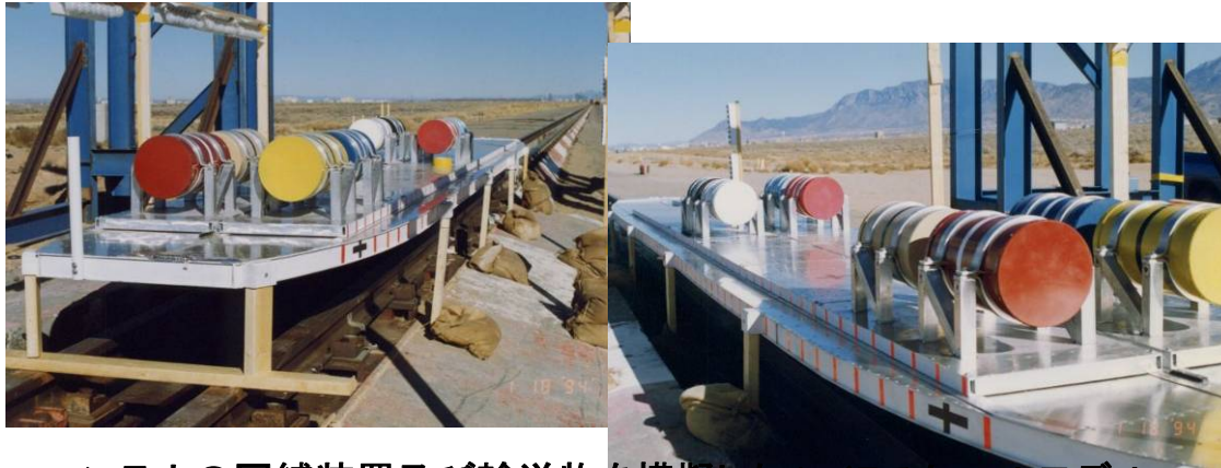
コンテナの固縛装置及び輸送物を模擬した1/5スケールモデル
