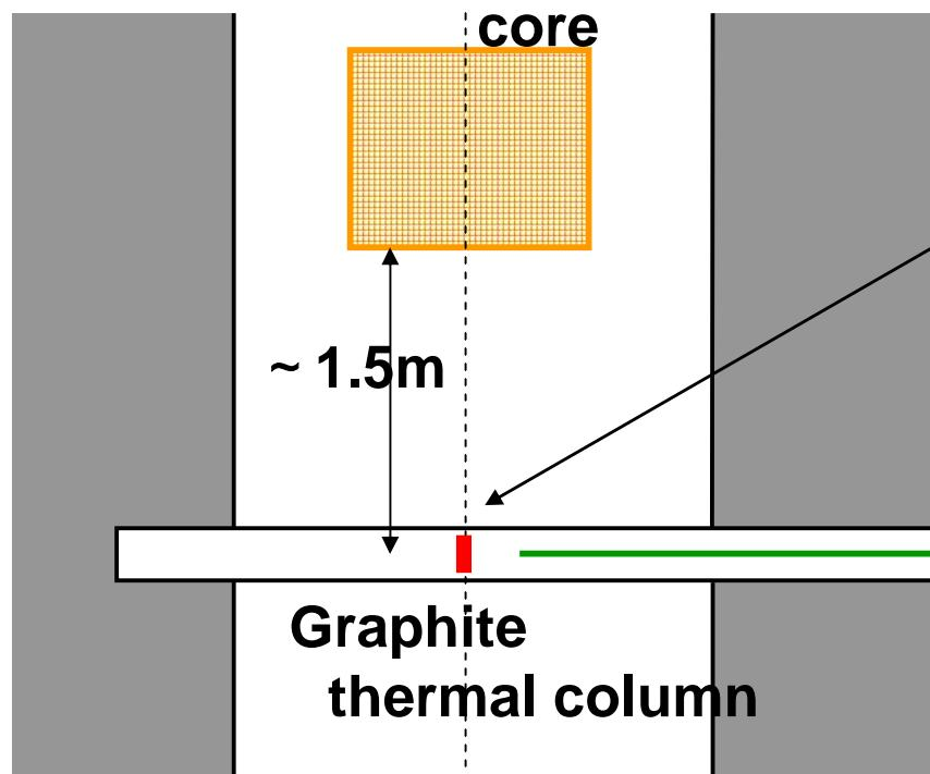
Flux  $\sim 6 \times 10^{11} \text{ n/cm}^2\text{s}$
