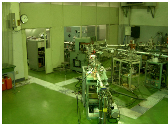
図 4 名古屋大学のバンデグラフ加速器。手前が重水素ガスターゲットのビームライン。
