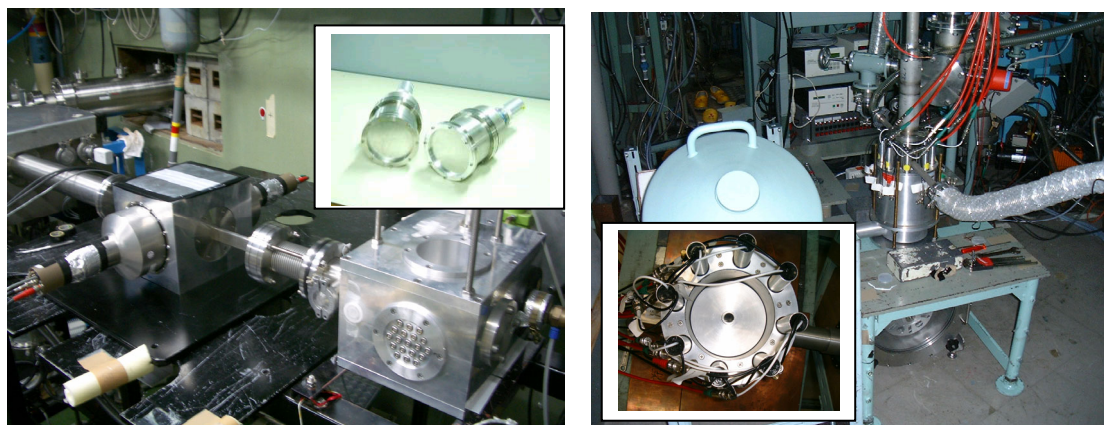
図2 JAEA-ISOL に設置した BGO 全吸収型検出器（左）と KUR-ISOL に設置した HPGe 全吸収型検出器（右）。中心部分にはいずれも不安定核を打ち込んだ薄いテープが走っている。
