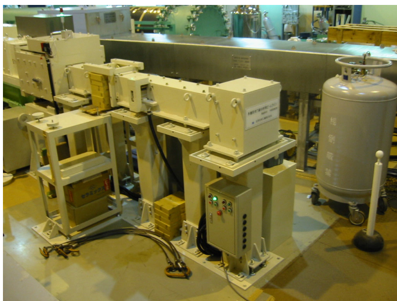
図 3 多重即発ガンマ線分光ビームライン (JRR-3M ガイドホール)
