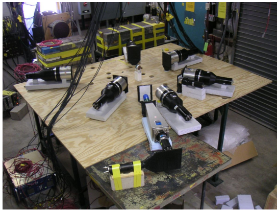
図1 ( n, xn ) 断面積測定用の検出器の配置
