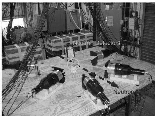
図 10 液体有機シンチレータで測定した時の実験室内の様子
