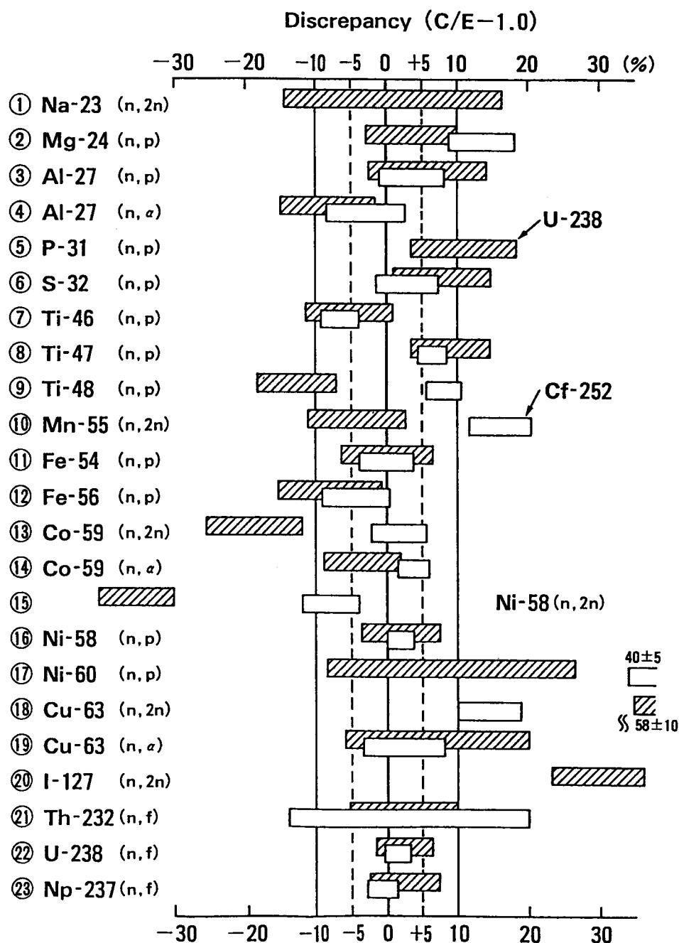
第1図 核分裂中性子スペクトル場における積分テスト結果
