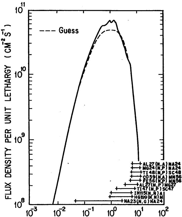
図 2 弥生炉グローリホールのunfolded neutron spectrum
