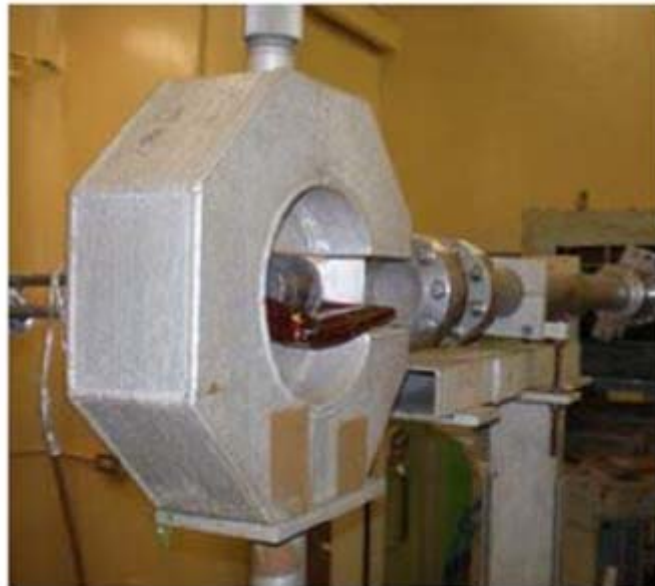
図 1 KURNS-LINAC のパックマン型中性子モデレータと Ta ターゲット
