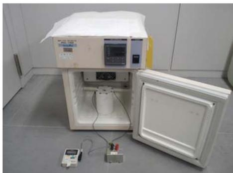
図 11 生物系試料による電気化学的起電力発生装置
