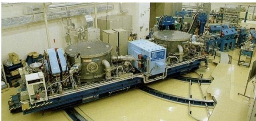
図 1 原子力機構タンデム加速器施設に設置されている反跳生成核分離装置
