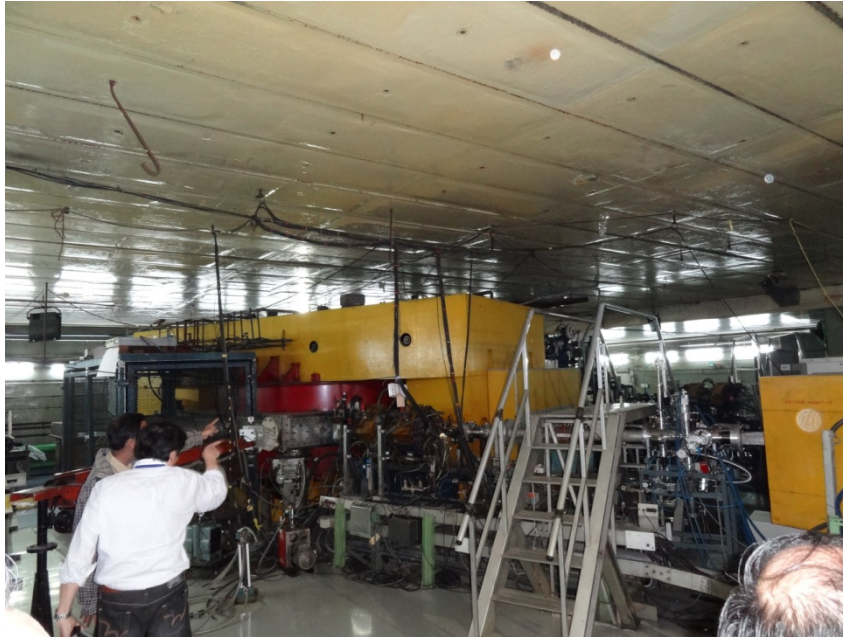
写真 5 : K=130 可変エネルギーサイクロトロン
