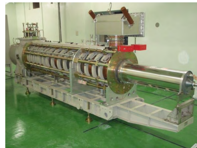
所定位置に設置したリニアック(上)と クライストロン(下)
