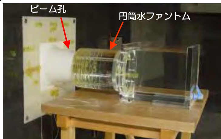
JRR-4のビーム特性評価のために 実施したファントム実験
