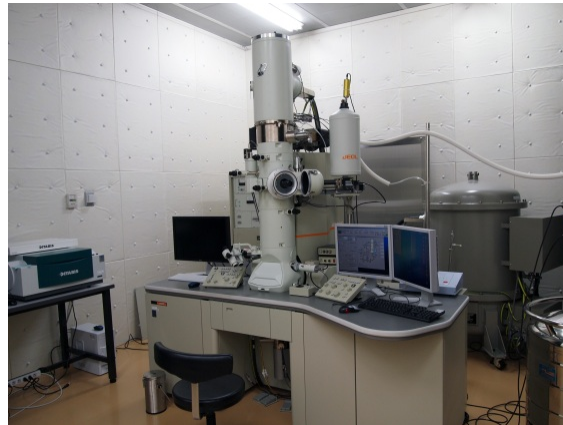
放射線管理区域に導入された FE-TEM。 EDS、EELS、STEM 解析などが可能。
