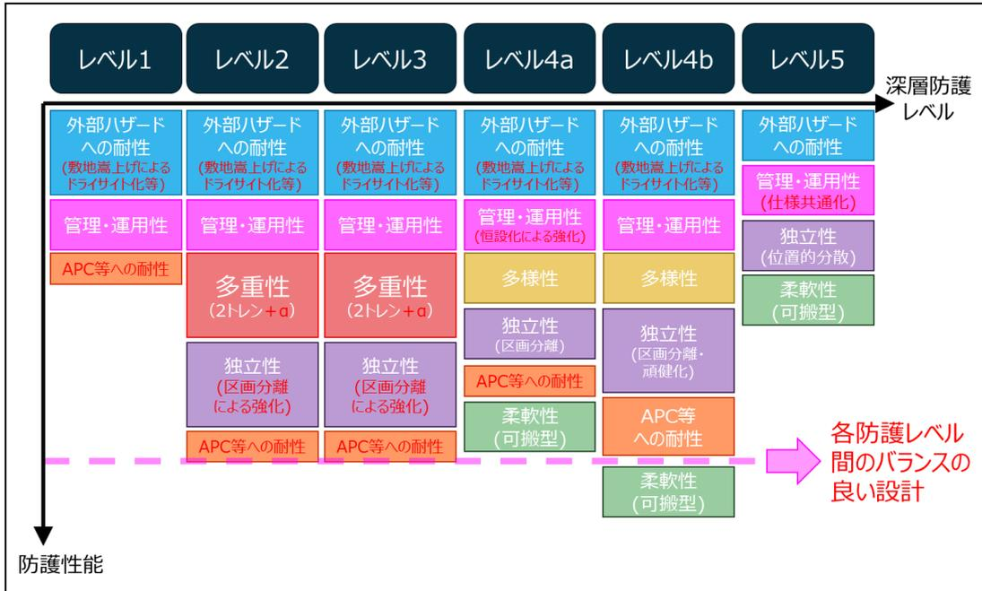
図 5.3-6 深層防護レベルの厚さのイメージ【次期軽水炉】
