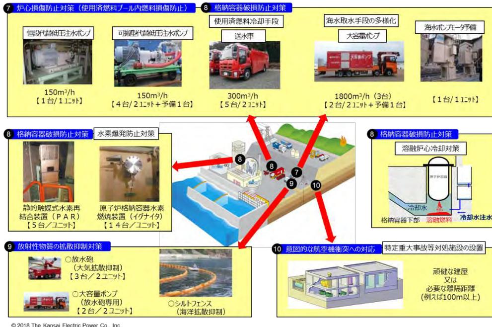
図 3.2-3 既設炉における新規規制基準対応(大飯 3,4 号機の例) (3/3)
