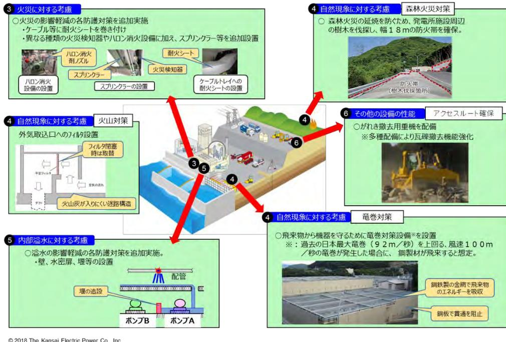
図 3.2-2 既設炉における新規制基準対応(大飯 3,4号機の例) (2/3)
