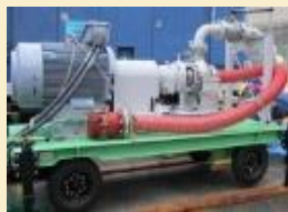
可搬式代替注水ポンプ
