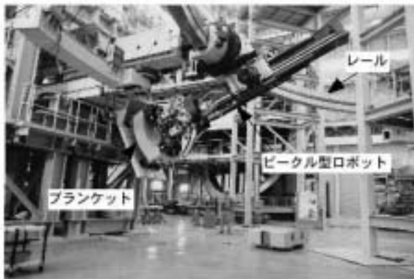
第 7 図 実規模ピークル型ロボットを用いたセンサーフィードバック制御によるブランケットの取付け試験
