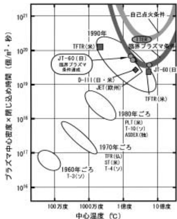
第 3 図 ローソン図とトカマク研究の進展 (関昌弘編, 核融合炉工学概論, 日刊工業新聞社(2001)より転載)
