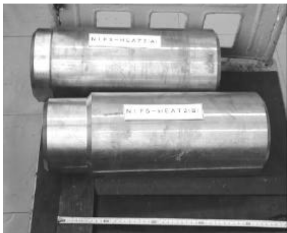
高純度 V-4Cr-4Ti 合金の 166kg インゴット (NIFS-HEAT-2(A)、(B))
