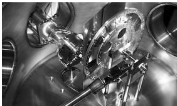
写真2 イオン照射装置内部（エネルギーディグレーダーホイールと照射ステージ）
