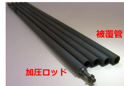
図31-2 SiC-SiC被覆管及び模擬燃料棒（加圧ロッド）の外観写真 [7]
