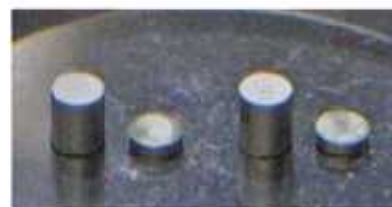
Sintered (Pu, Zr)N pellets
