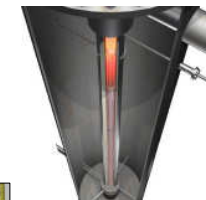
事故を模した加熱状態への下部からの注水
