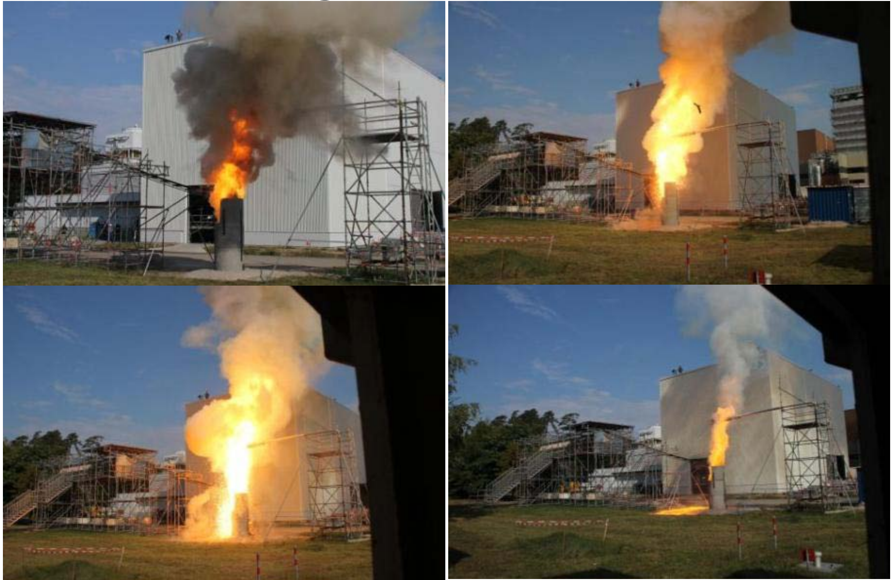
テルミット反応で模擬溶融コリウムを形成、MCCI模擬試験
