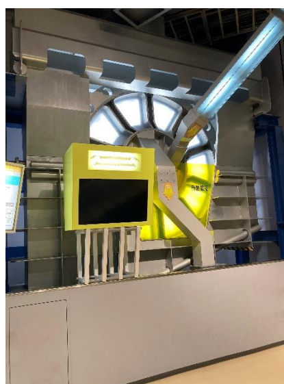
せん断した燃料棒を溶解分離する模型
