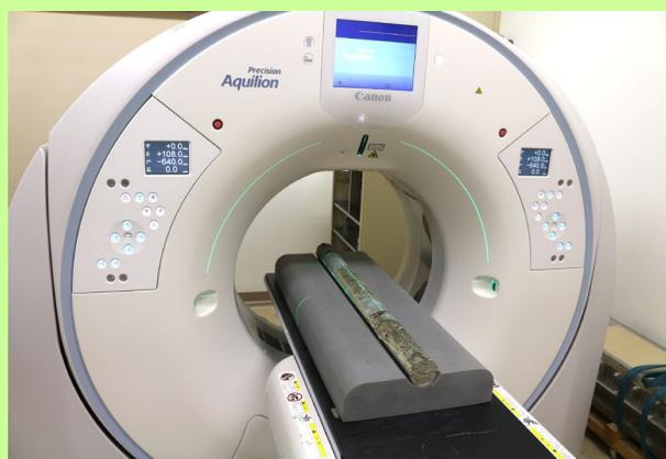
断層破碎帯試料(ボーリングコア)のX線CT撮影
